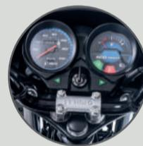
Medidor de combustible y testigo de pata
