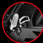
Mono amortiguador ajustable en 7 posiciones
